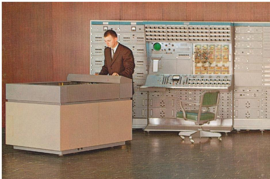
les principaux avantages de ces calculateurs par rapport aux «calculatrices arithmétiques», les ordinateurs numériques ou binaires de l'époque qui, par comparaison, travaillaient en *batch*: il fallait leur livrer une pile de cartes perforées et attendre le résultat, qui ne parvenait que plusieurs heures plus tard, là où les calculateurs analogiques donnaient un résultat en quelques secondes.
